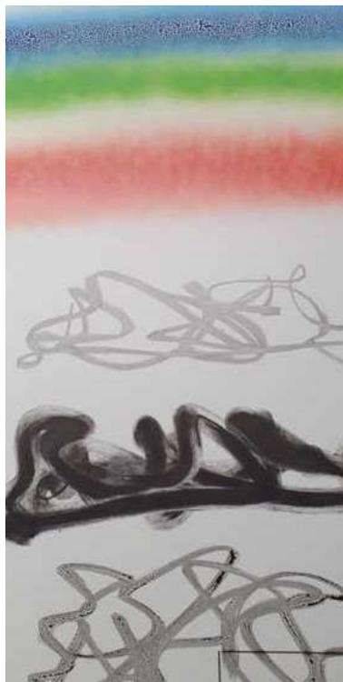
Die ganze Bandbreite an Farbstiften und Spraylacken kann von der Schutzbeschichtung entfernt werden.
